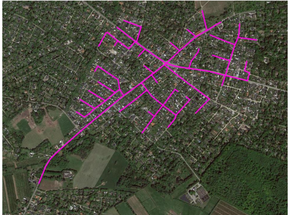
Figur 5-2 Oversigt over det nye ledningsnet i Asserbo
